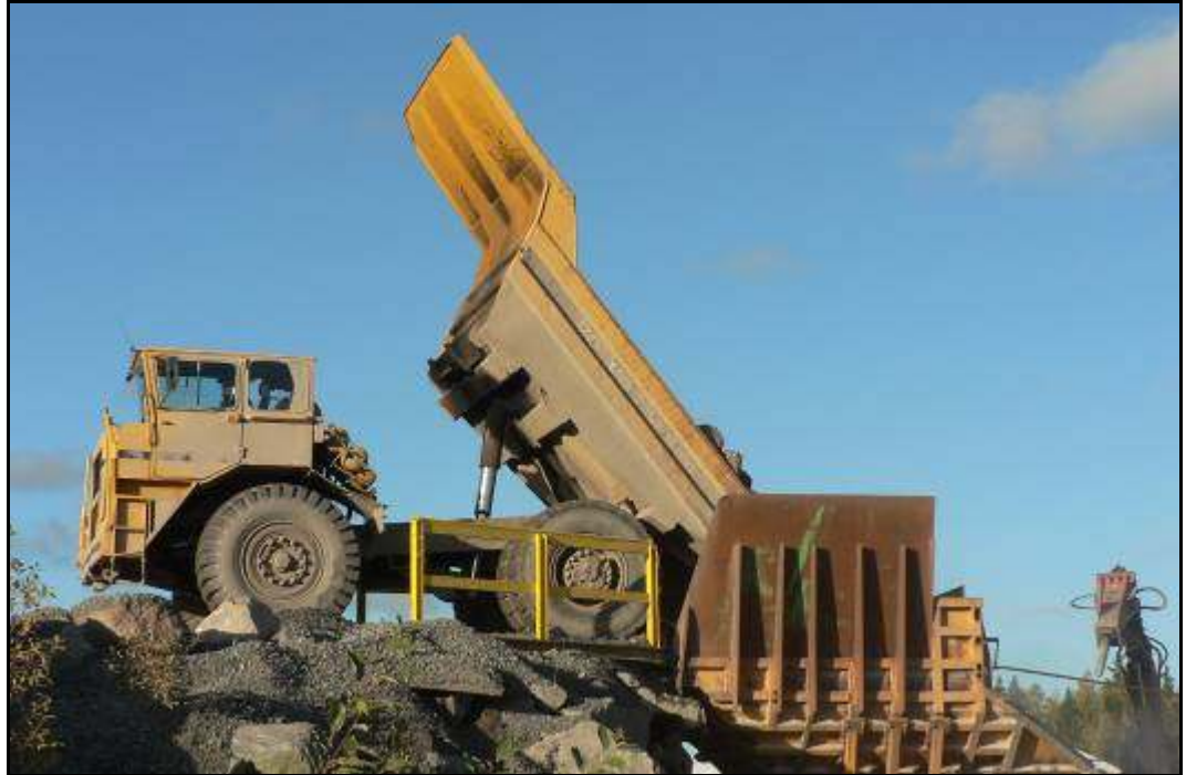
Kuva 9. Louheen kippaus murskauslaitokseen.
