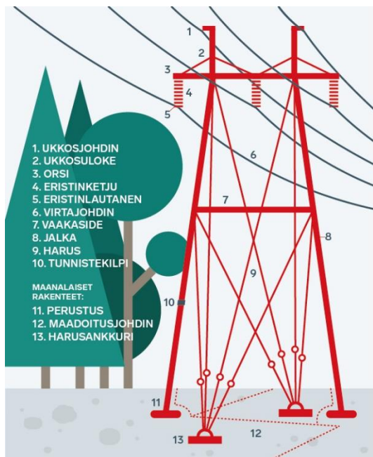
Kuva 4-1 Voimajohdon osat (Fingrid 2020).
