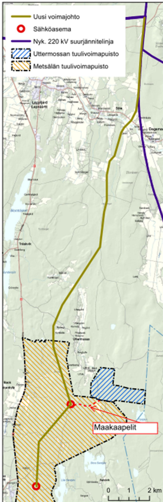
Kuva 7. Sähkösiirtoreitti (110 kV) Metsälästä Pyhävuorelle. Kuvassa alustava suunnitelma saman sähköaseman ja sähkösiirtolinjan hyödyntämisestä sähkösiirrossa. Metsälän osayleiskaavan raja on merkittynä oranssilla ja Uttermossan hankerajaus sinisellä vinoviivoituksella.
