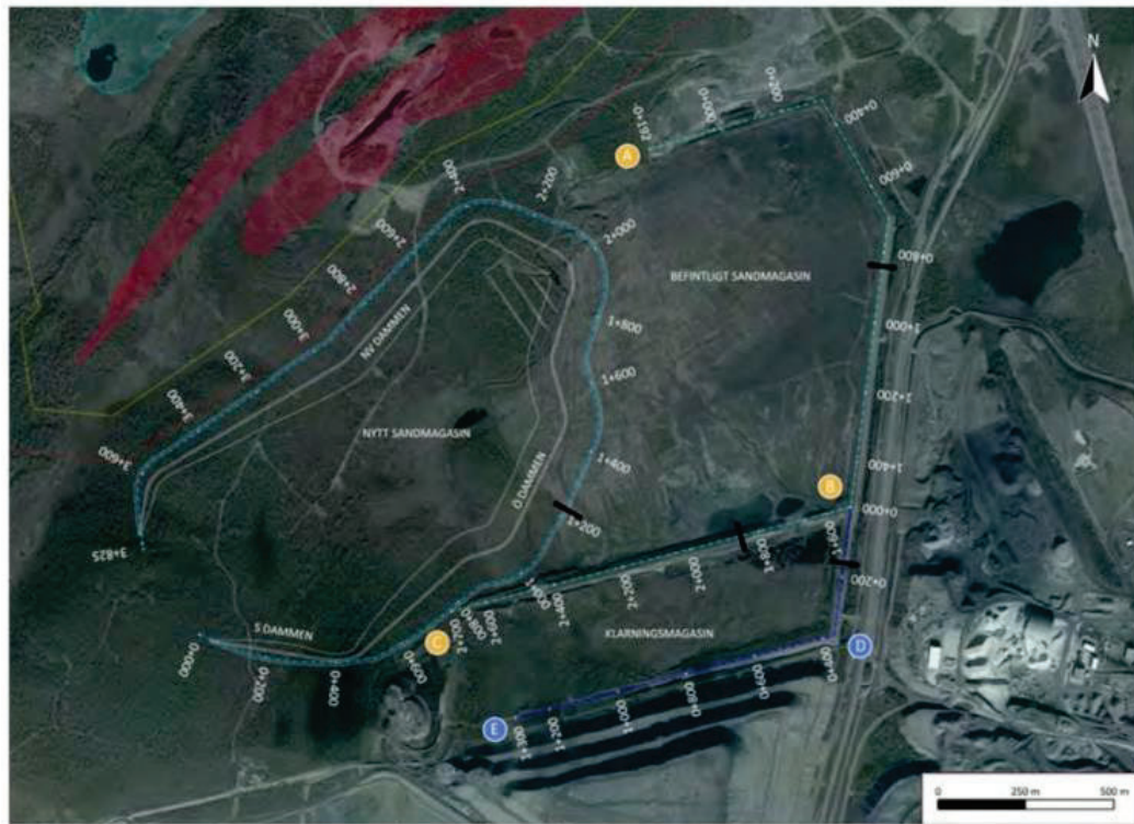
Kuva 5. Yleiskuva toimenpiteen lammikoista. Vanhan hiekka-altaan lammikot (Lammikko A-B ja Lammikko B-C) selkeytysaltaan ympärillä (Lammikko B-C, Lammikko B-D ja Lammikko D-E) ja uuden hiekka-altaan lammikot (Lammikko NV, (luoteessa), Lammikko S (etelässä) ja Lammikko Ö (idässä)).
