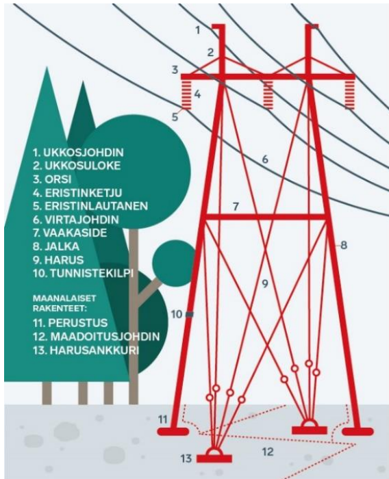
Kuva 3-5. Voimajohdon osat (Fingrid 2021).
