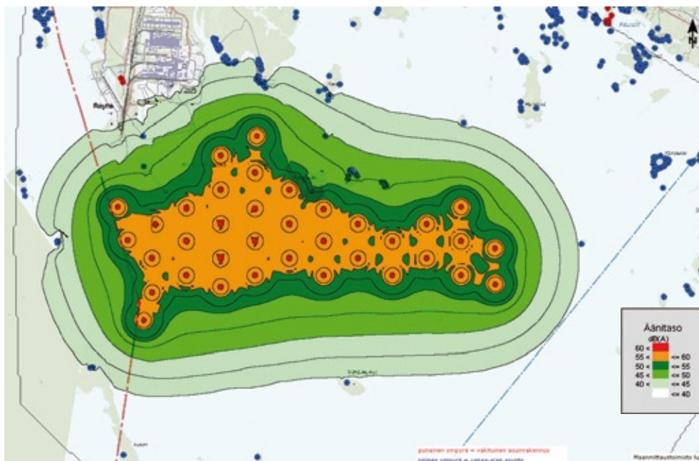
Kuva 5-60. Tuulivoimalaitoksen meluvaiikutus vaihtoehdossa 1.
