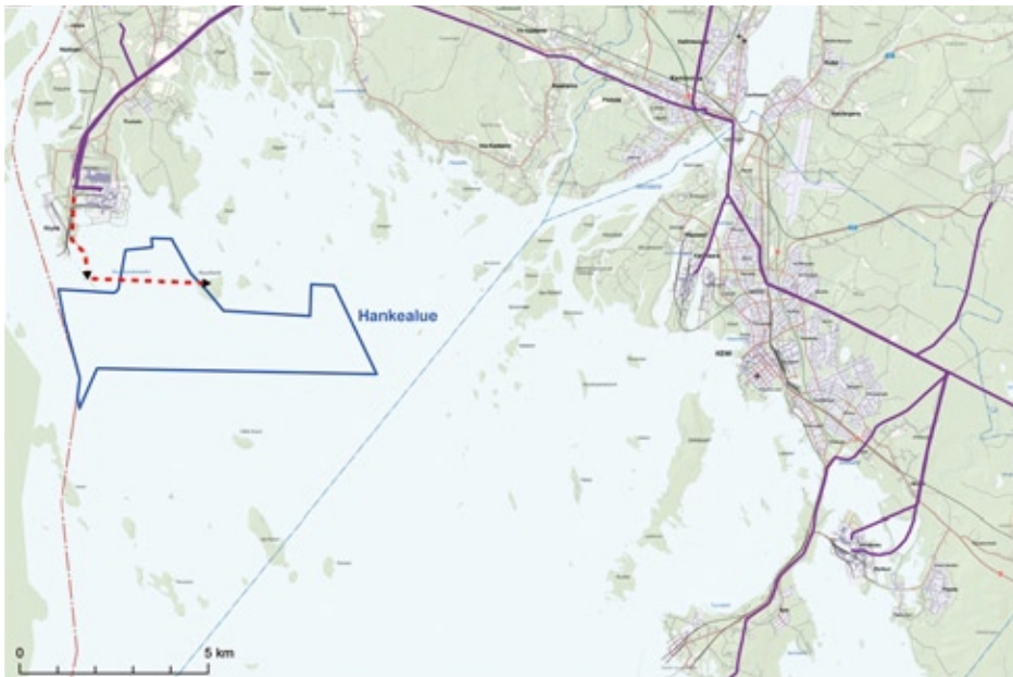
Kuva 3-13. Suunnitelmapöytäkuva tuulivoimapuiston sähköasemien kytkeästä Selleen sähköasemalle.
