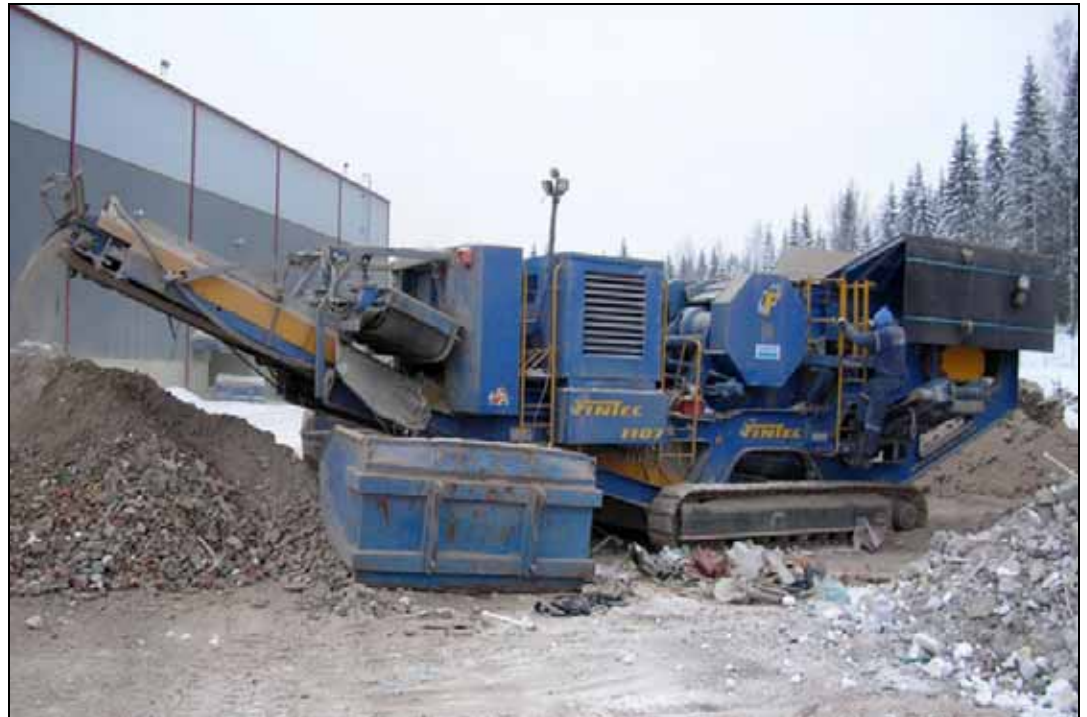
Kuva 8. Siirrettävä leukamurskain Fintec 1107.
