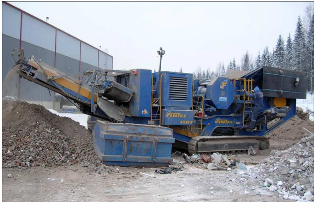
Kuva 5. Siirrettävä leukamurskain Fintec 1107.
