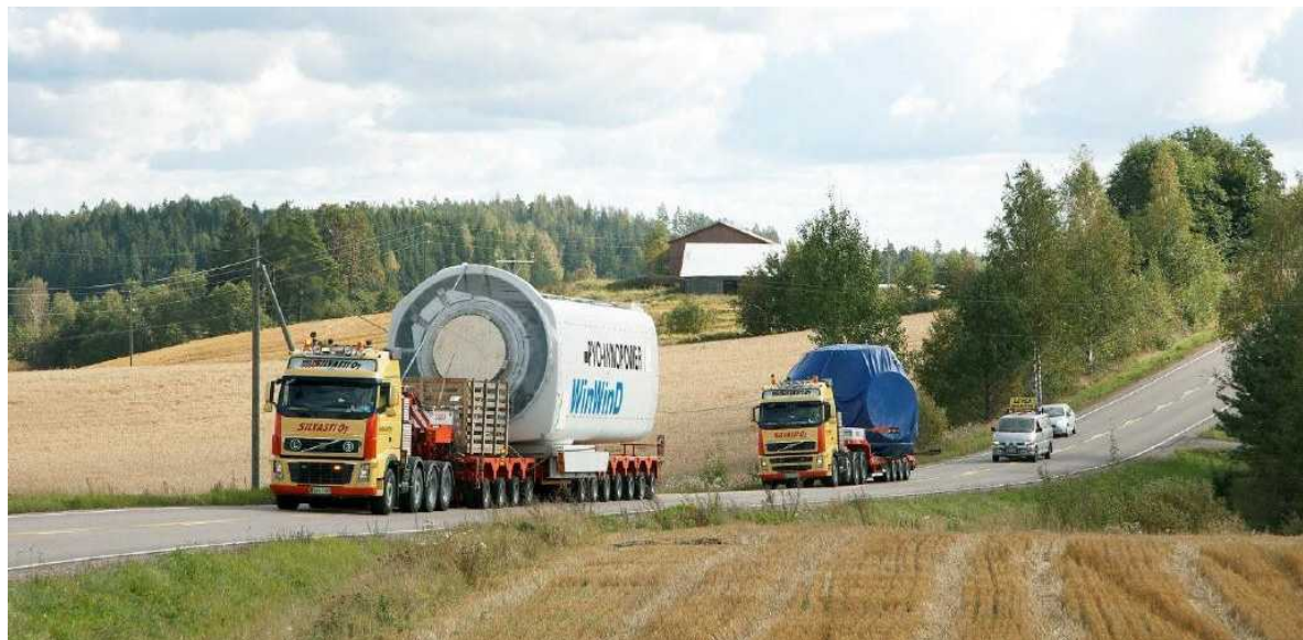
Kuva 100. Tuulivoimalan konehuoneen ja navan erikoiskuljetukset (Ville Silvasti Oy).
