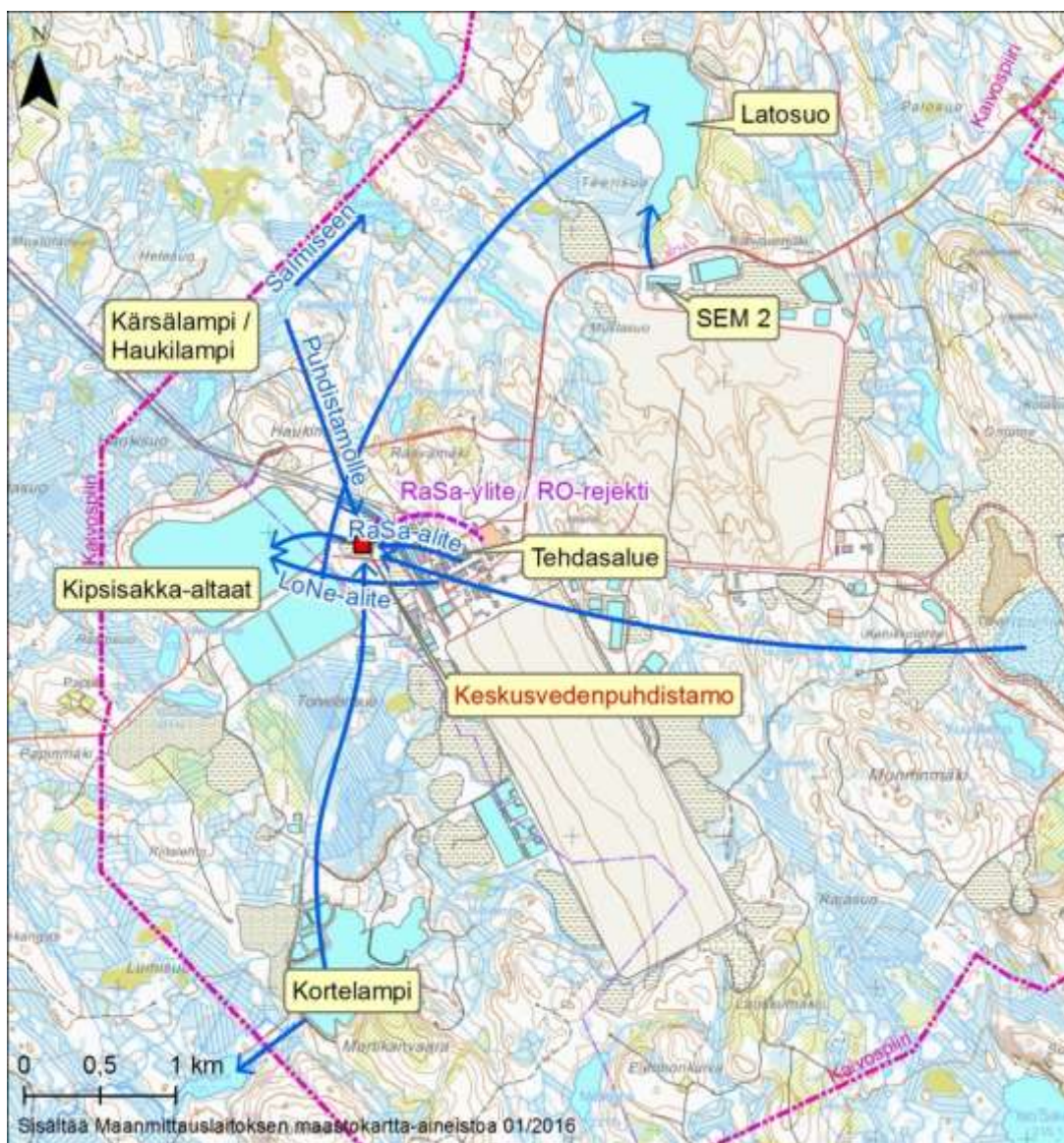
Kuva 4-18. Kaivosalueen vesien johtaminen keskuspuhdistamon käyttöönoton jälkeen.
