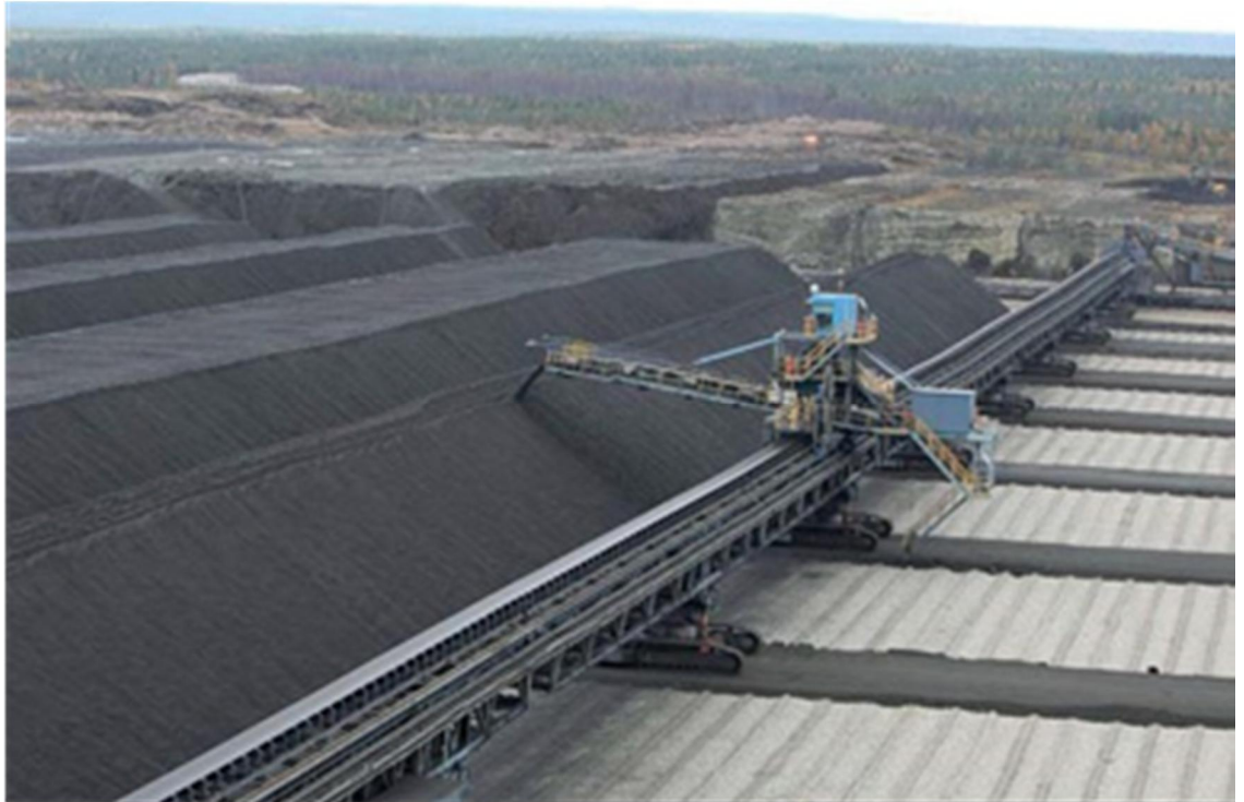
Kuva 3-7. Primääriliuotuskasan täyttö sähkökäyttöisellä kasauslaitteistolla (ns. stakkerilla) (Ramboll Finland Oy 2012).
