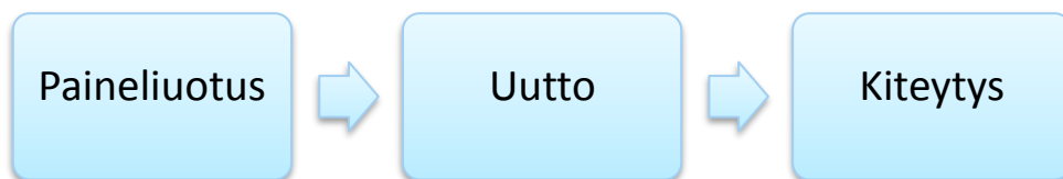
Kuva 3-5. Nikkeli- ja kobolttisulfaattien valmistuksen päävaiheet.
