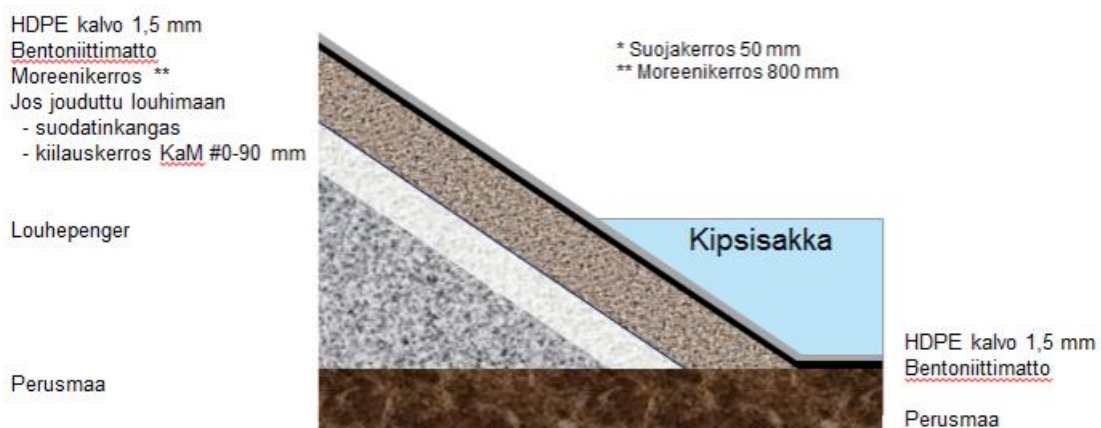
Kuva 3-12. Kipsisakka-allas 2 (lohkot 3-6) korotusosat sekä uuden kipsisakka-altaan 3 ympäristöluvassa esitetty rakenne lohkoille tulevat lohkot 7 ja 8. (Pöyry Finland Oy 2018)
