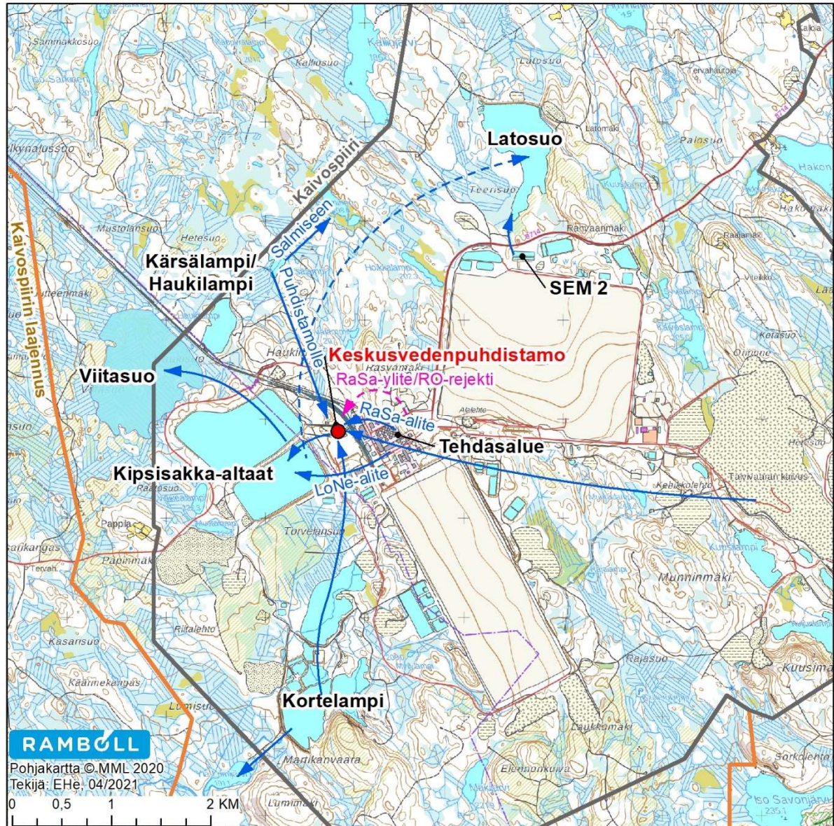
Kuva 5-31. Vesien johtaminen kaivospiiri sisällä.
