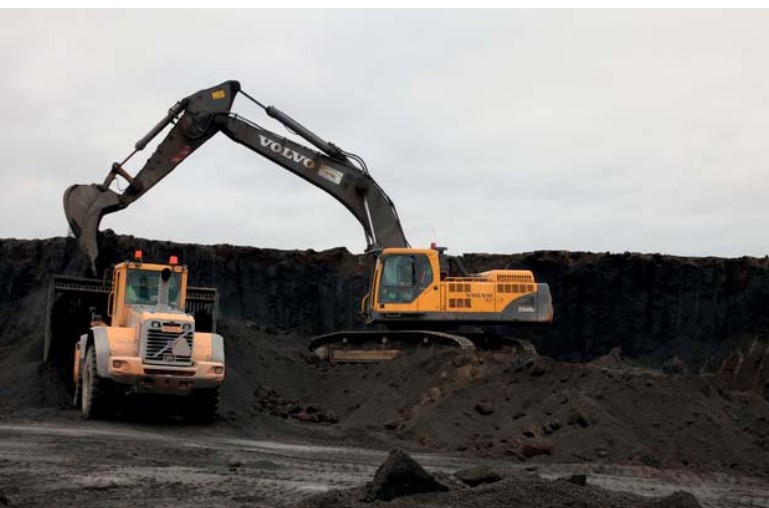
Kuva 2-12. Bioliuotuskasan purku käynnissä.
