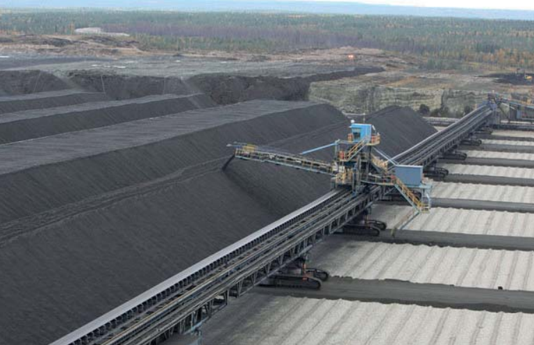
Kuva 2-10. Primääriliuotuskasan täyttö stakkerilla.
