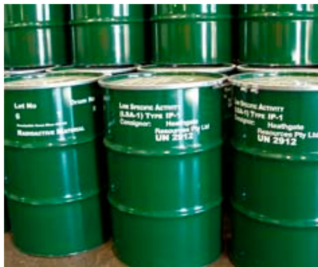
■ Kuva 5-5. Esimerkki uraanipuolituotteen kuljetuksissa käytettävästä tynnyristä (kuva: O. Äikäs, GTK, 2008).
