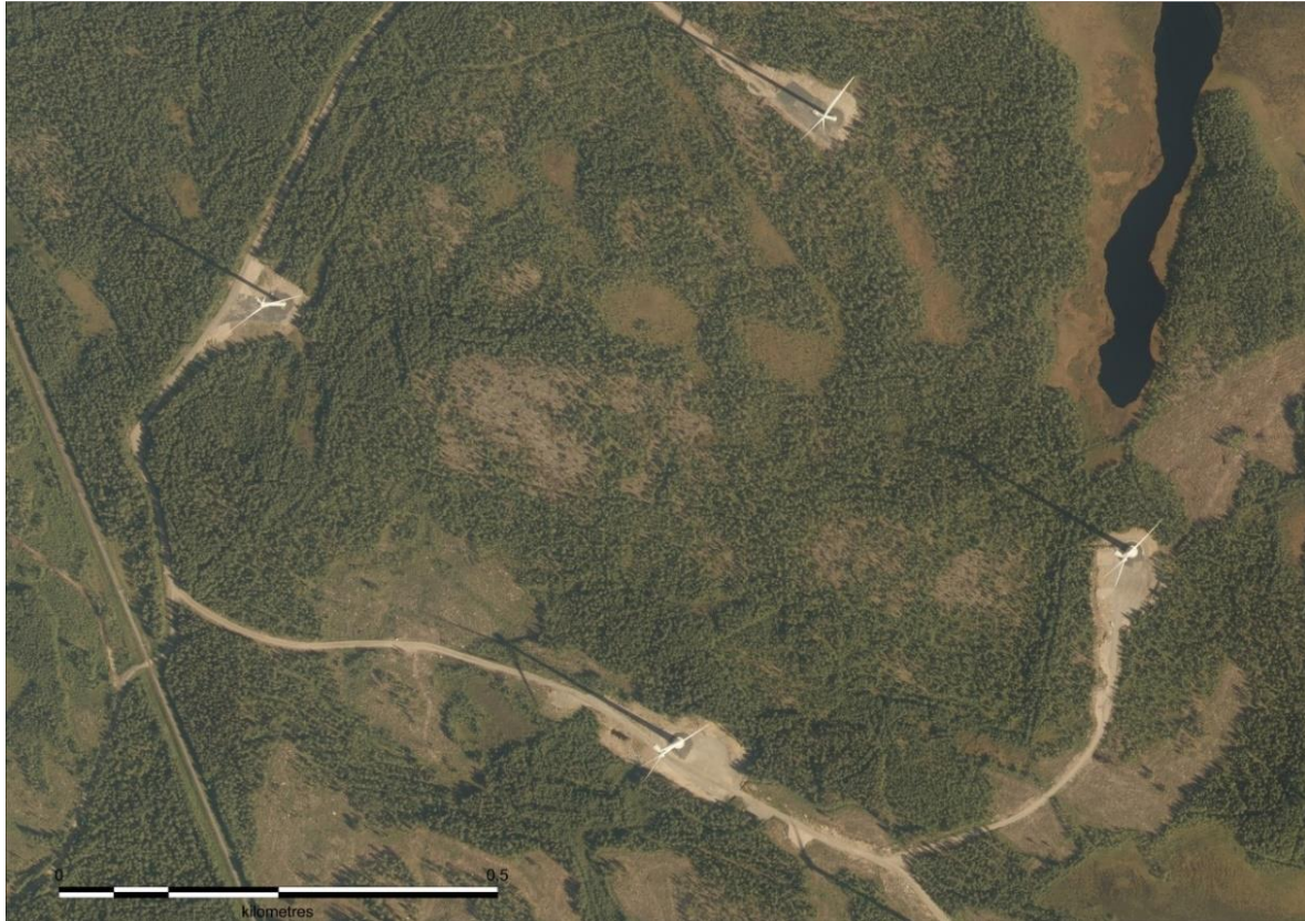
Kuva 4.1 Esimerkkikuva toiminnassa olevasta tuulivoimapaistosta. Tuulivoimaloita varten on rakennettu huoltotiet ja nostokentät. Tuulivoimaloiden ympäristössä ja välialueilla aikaisempi maankäyttö on säilynyt ennallaan.
