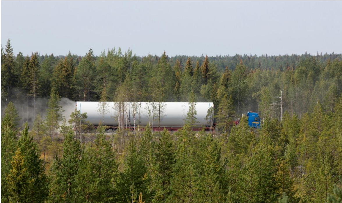
Kuva 4.18 Tuulivoimalan torniosien kuljetusta (FCG Finnish Consulting Group Oy).
