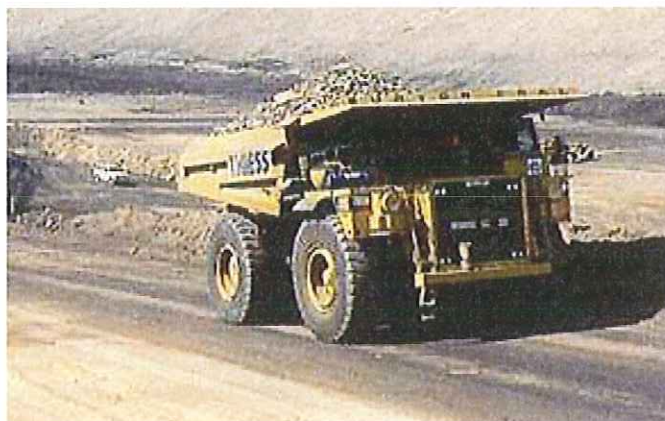
Kuva 5. Louheenkuljetus-dumpperi Caterpillar (malli- 789), jonka kapasiteetti on 177 tonnia.
