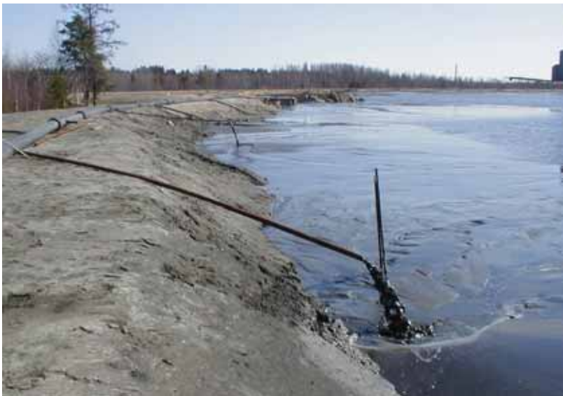
Kuva 7.2. Rikastushiekan läjitystä rikastushiekka-altaaseen Pyhäsalmen kaivoksella.
