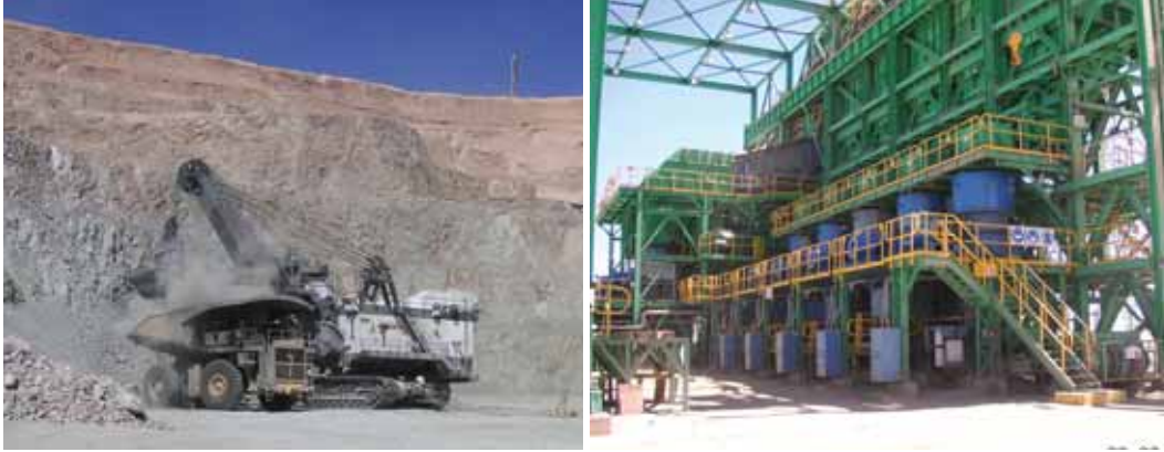
Kuva 4.9. Louheen lastaus ja laitos malmin toisen ja kolmannen vaiheen murskaukseen.
