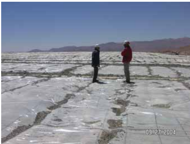
Kuva 7.7. Bioliuotuskasan kasteluputkistot ja kasaa peittävä muovikalvo.
