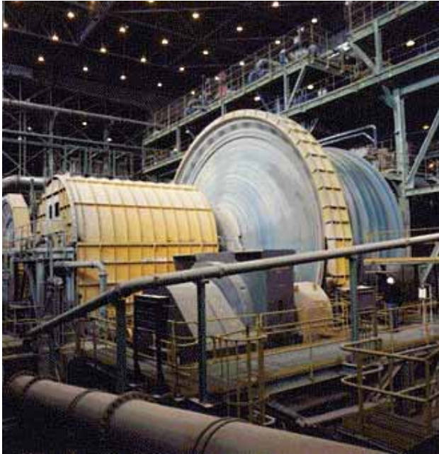
Kuva 7.1. Malmin jauhatuksessa käytetty autogeenimylly (kuvan lähde: www.metsominerals.com ).
