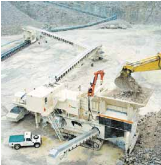
Kuva 4.10. Louhoksessa oleva murskaamo ja murskatun kiven kuljettimet (kuvan lähde: www.metsominerals.com ).
