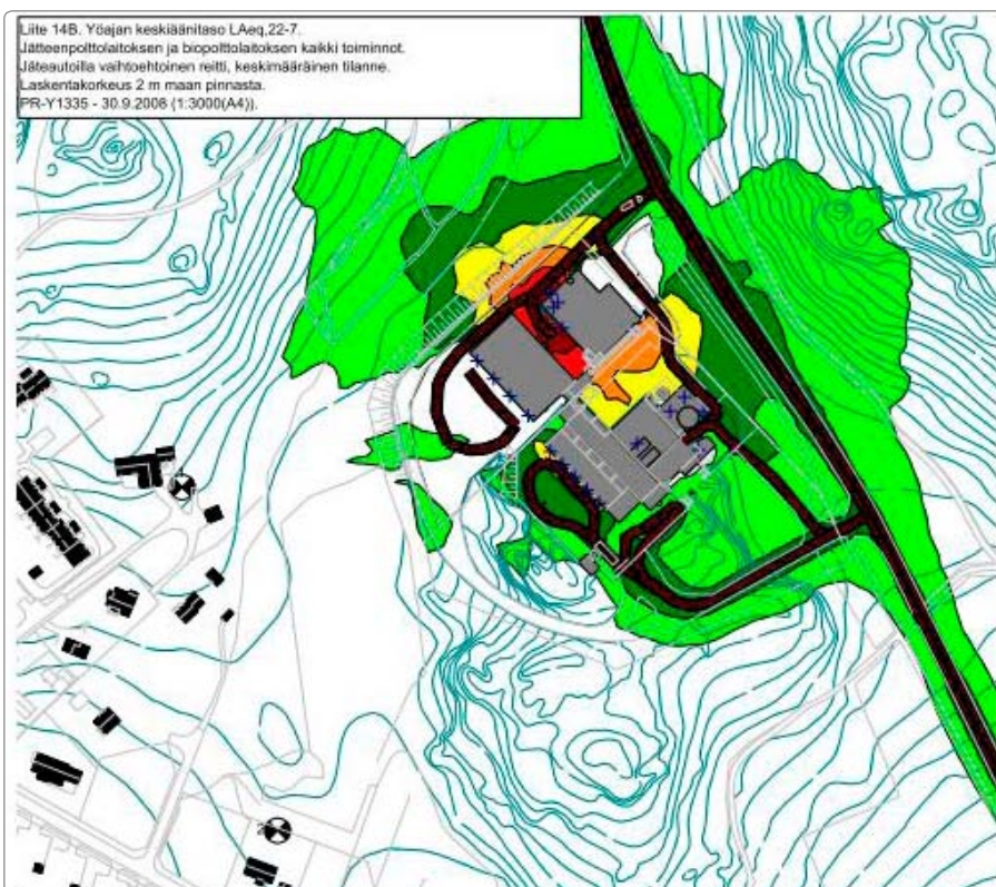
Kuva 6-66 Orikedon jätteenpolttolaitoksen ja biolämpökeskuksen L_{Aeq,22-7} mallinnetut meluvyöhykkeet (yöllä)
