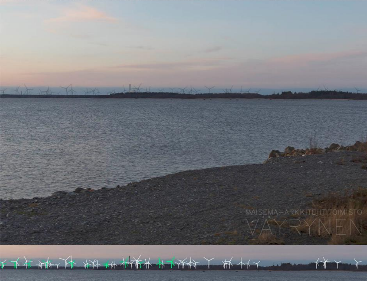
Kuva 8-24. Havainnekuva L Reposaaaren maantieltä. Yläkuvan objektiivi on 16 mm ja alakuvan 50 mm. Alhaalla on valkoisella osoitettu uudet voimalat ja vihreällä olemassa olevat Tahkoluodon merituulipuiston voimalat. Lähimpään hankkeen tuulivoimalaan on etäisyyttä yli 11 km.
