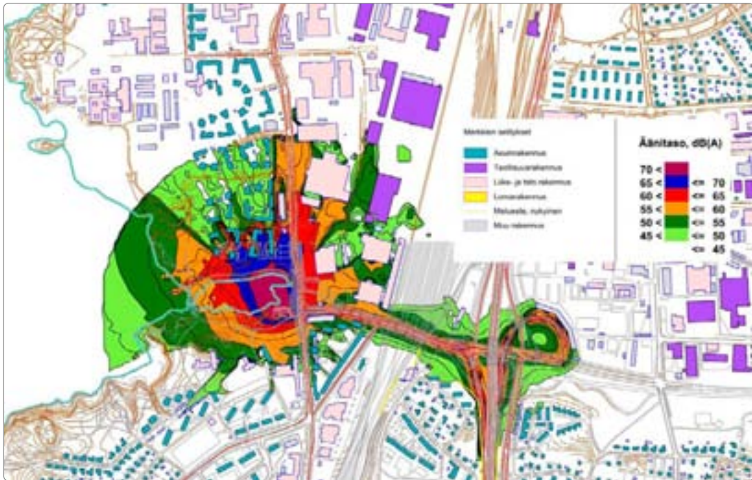
Kuva 24-12. Vihilahden suuaukon louhinnan meluvyöhykkeet LAeq 1h
