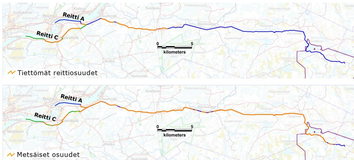
Kuva 25-3. Purkuputkireitin tiettömät osuudet kaivospiirin ulkopuolella (ylempi kuva) ja metsäiset osuudet putkireitin varrella (alempi kuva).
