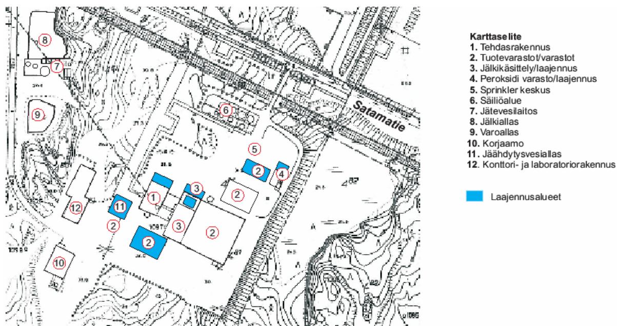
Kuva 3-2 Laajennusvaiheiden vaatima rakentaminen
