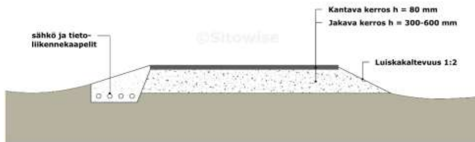
Periaatekuva uuden ja perusparannettavan tien rakenteesta.
