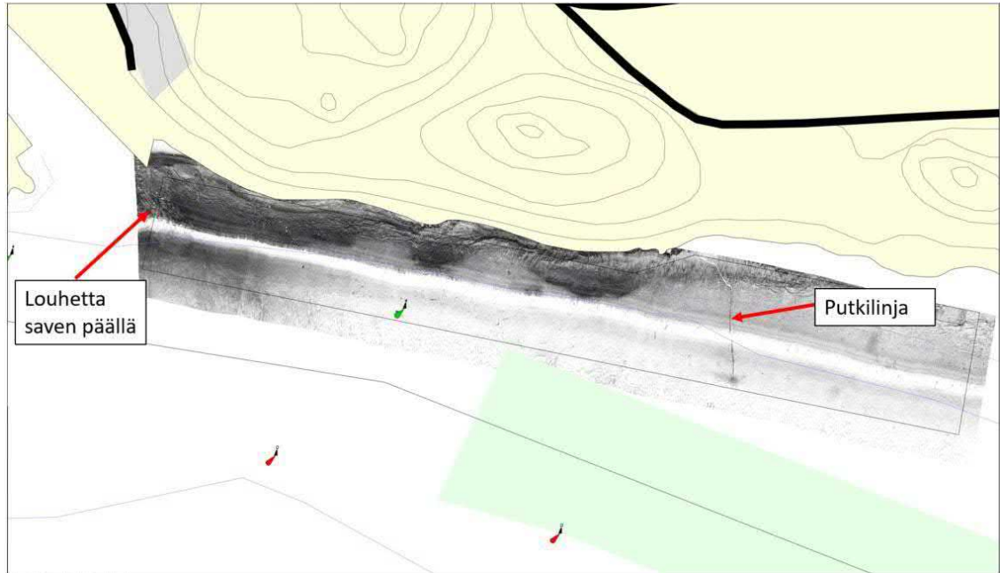
Kuva 5. Viistokaikuluotaimen tuottama kuva tutkimusalueesta. Kuvasta havaitaan selkeästi tummemmat rannan läheiset alueet, joissa kallio on lähellä pintaa ja vaaleammat alueet, joissa on liejusavipinta. Saven päälle läjitetty louhe ja putkilinja on merkitty kuvaan nuolilla.
