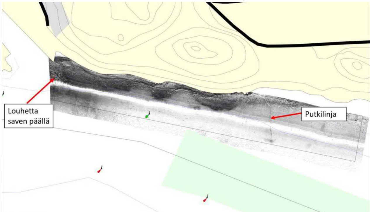
Kuva 1. Viistokaikuluotaimen tuottama kuva tutkimusalueesta. Kuvasta havaitaan vaaleammat alueet, joissa on liejusavipinta. Saven päälle läjitetty louhe ja putkilinja on merkitty kuvaan nuolilla. (Hämäläinen 2020)
