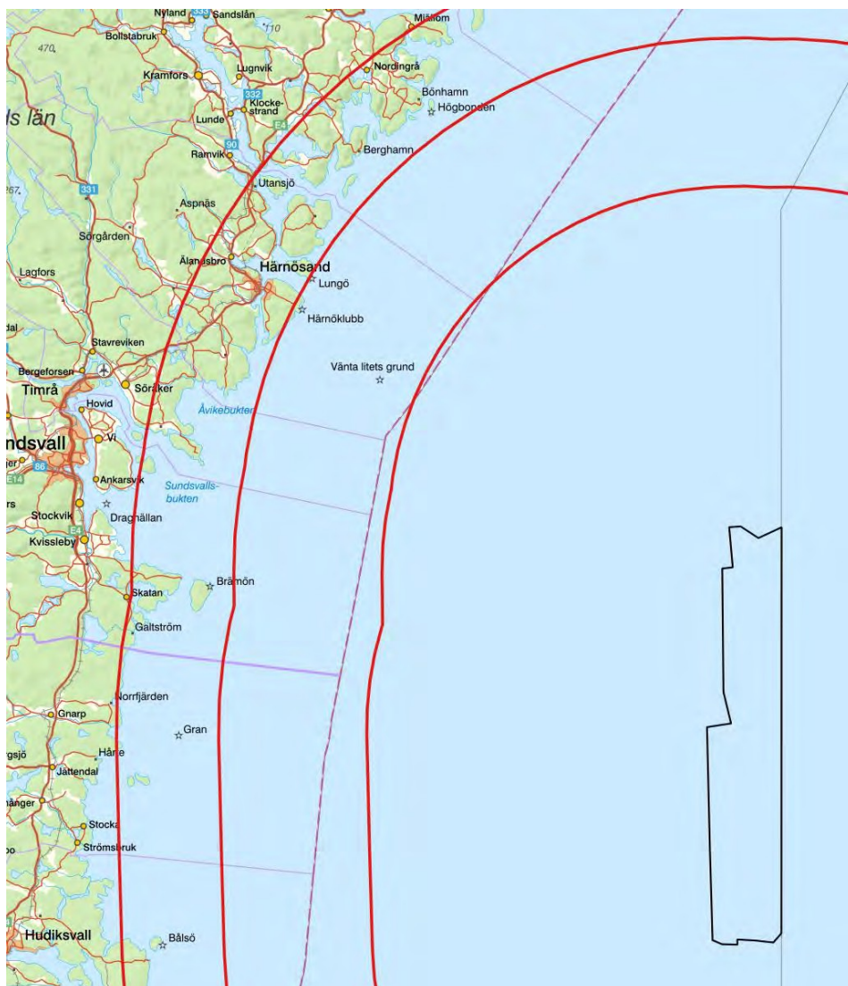
Kuva 39. Punaiset viivat osoittavat, kuinka kaukana tuulivoimapaistosta on teoreettisesti mahdollista nähdä 180 metrin korkeudella oleva napa täydessä näkyvyydessä ennen kuin se katoaa horisontin alle. Sisin viiva vastaa näköyhteyttä, jos havaitsija on merenpinnan tasolla (2 metriä merenpinnan yläpuolella), keskimäinen viiva, jos havaitsija on 62 metriä merenpinnan yläpuolella ja uloin viiva, jos havaitsija on 152 metriä merenpinnan yläpuolella.
