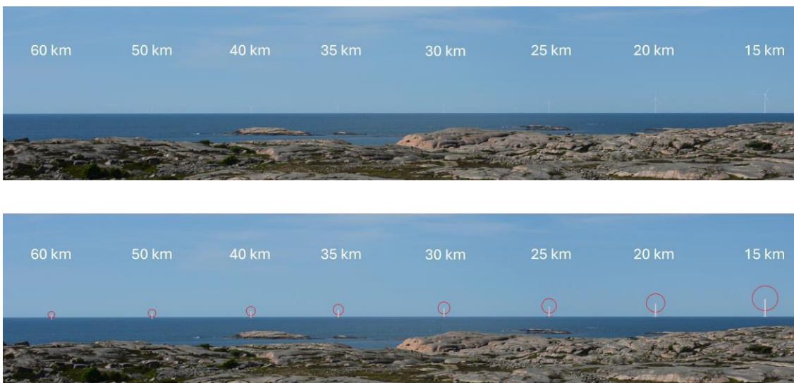
Kuva 7-10. Kuvassa esitetään valokuvamontaasin avulla, miten 370 metriä korkea tuuliturbiini näkyy eri etäisyyksiltä (15-60 kilometriä). Näkymä on kirkas ja katsoja on 28 metriä merenpinnan yläpuolella. Alemman kuvan punaiset ympyrät kuvaavat roottorin lapoja. Kuva liitteestä 10.
