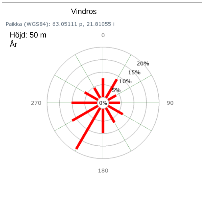
Bild 13–2. Vindros för 2 500 m-cellen i vindatlasen som visar vindriktningen för projektområdet och dess omgivning. Källa: Den finska vindatlasen (Ilmatieteen laitos, 2009).
