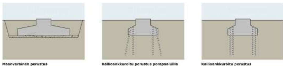
Kuva 3-4. Periaatekuvat tuulivoimalan vaihtoehtoisista perustamistavoista.
