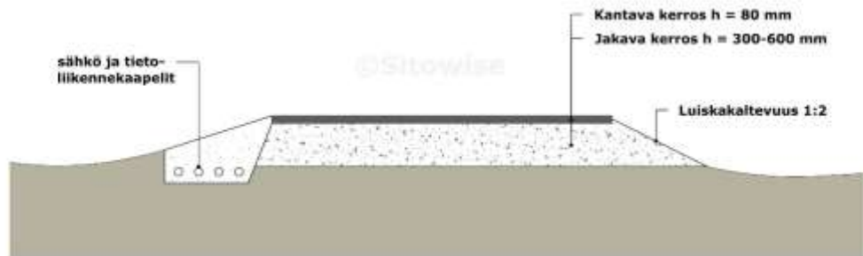
Periaatekuva uuden ja perusparannettavan tien rakenteesta.
