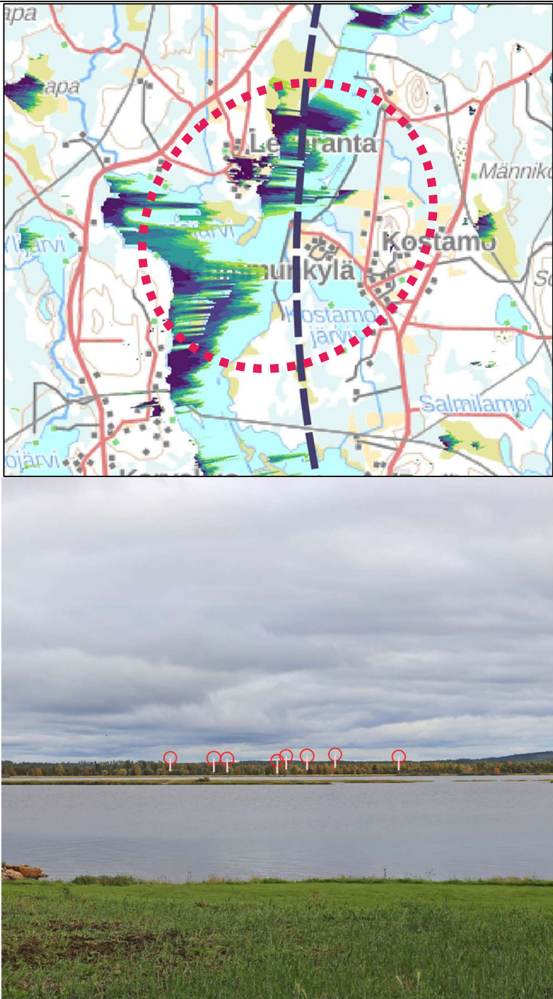
Leike Levärannan VE1 ja VE2 havainnekuvasta, jossa voimalat on tuotu etualalle. Näkyvät osat ovat puurajan yläpuoliset punaisin ympyröin korostettujen lapojen ja valkoisella värillä korostettujen tornien osuudet.
