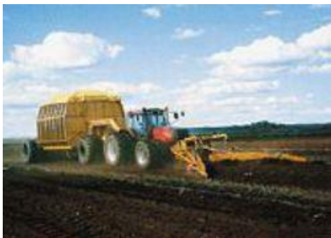
Kuva 4-2. Kokoojavaunumenetelmän karheamisen ja kokoamisen työvaihe. Lähde: Vapo Oy.
