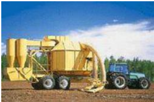
Kuva 4-4. Kokoaminen imuvaunulla. Lähde: Vapo Oy.
