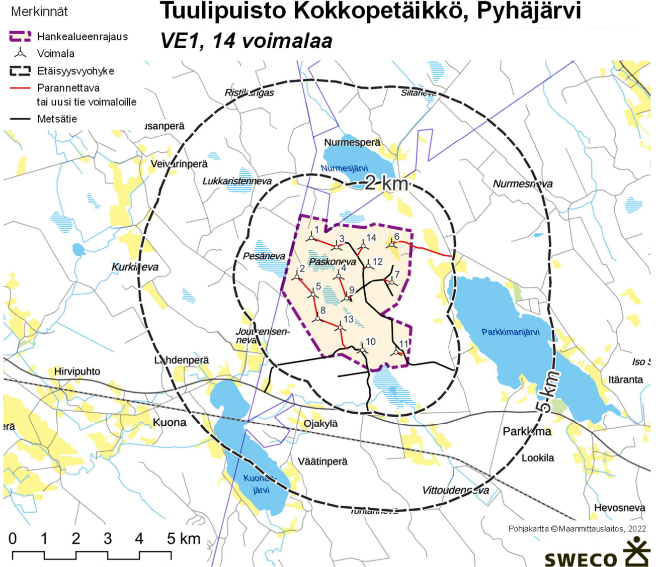
Kuva 2. Alustava voimalasijoittelu VE1 (14 voimalan hanke).
