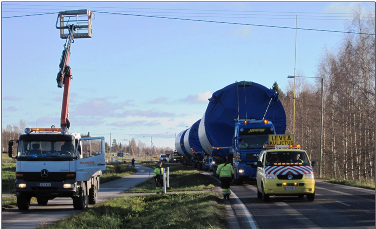
Kuva 10-15. Tuulivoimalan tornin osien erikoiskuljetus (Etelä-Pohjanmaan ELY-keskus).
