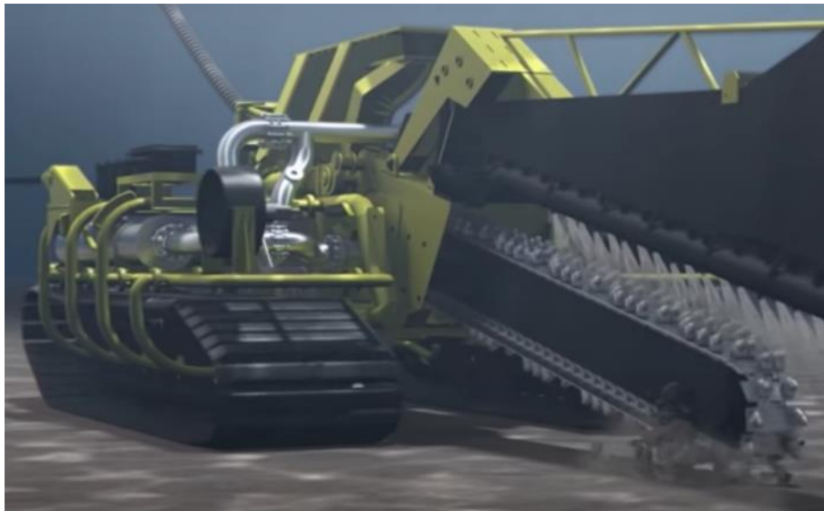
Figur 3.12. Exempel på mekanisk muddringsmaskin (källa: www.boskalis.com )
