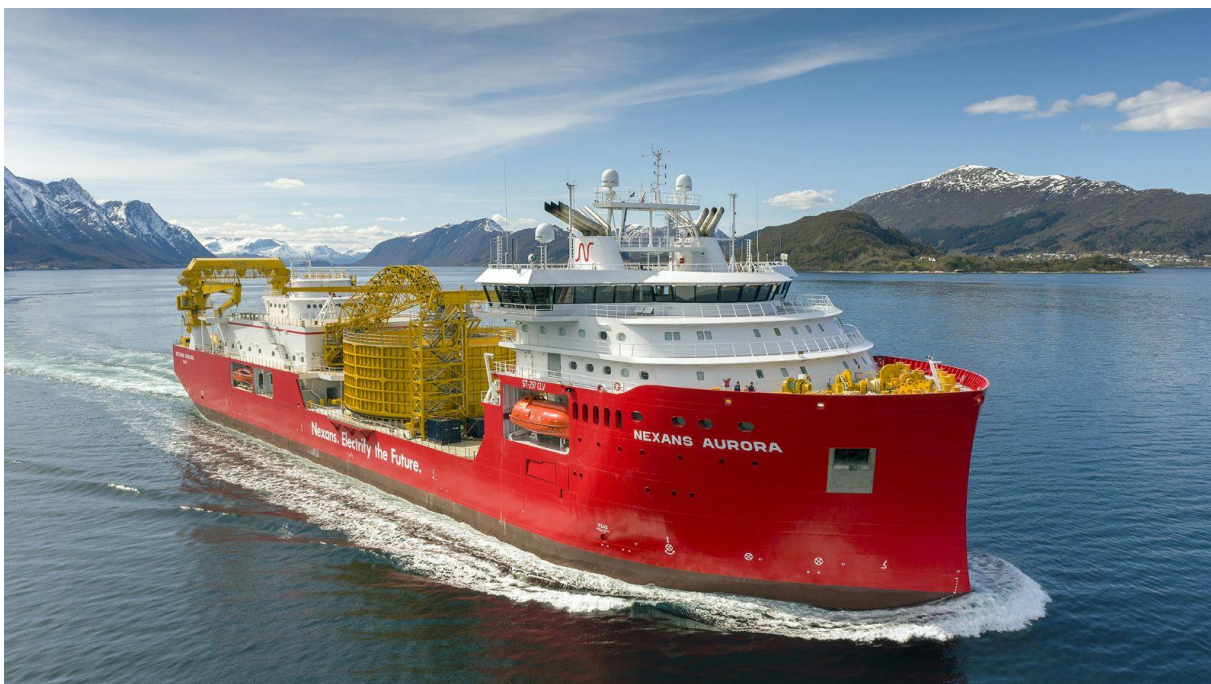
Figur 3.9. Exempel på ett kabellägningsfartyg som används för förläggning av undervattenkablar (källa: https://www.nexans.com/ )
