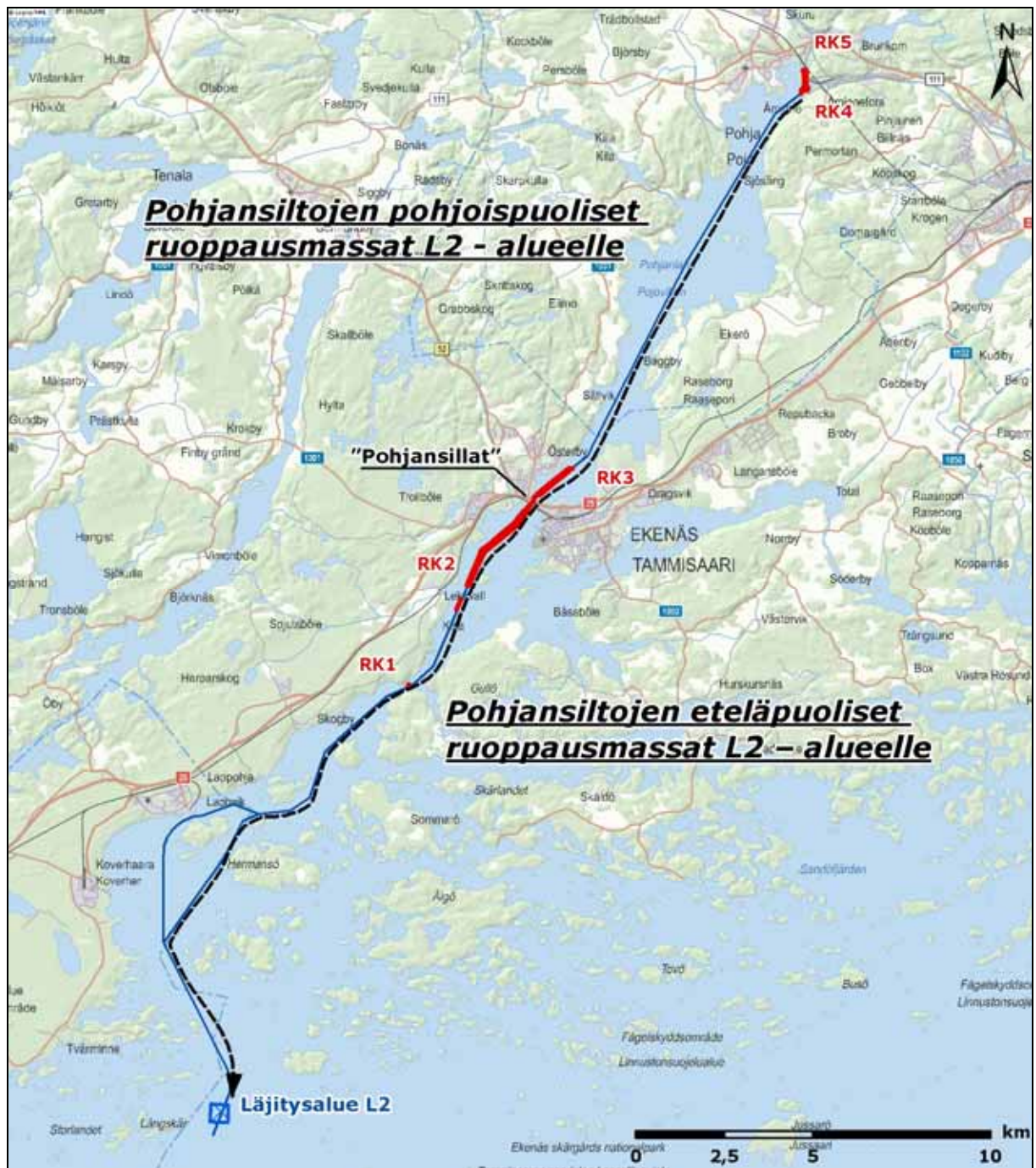
Kuva 4.3. Periaatekuva sedimenttimassojen läjityksestä vaihtoehdossa 3. Vaihtoehdossa 3 kaikki ruopattavat sedimenttimassat läjitetään Tammisaaren saaristossa sijaitsevalle läjitäysalueelle L2.
