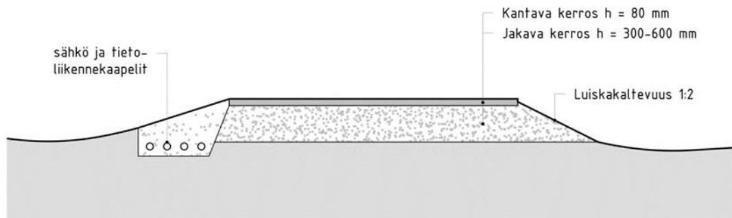
Periaatekuva uuden ja perusparannettavan tien rakenteesta.
