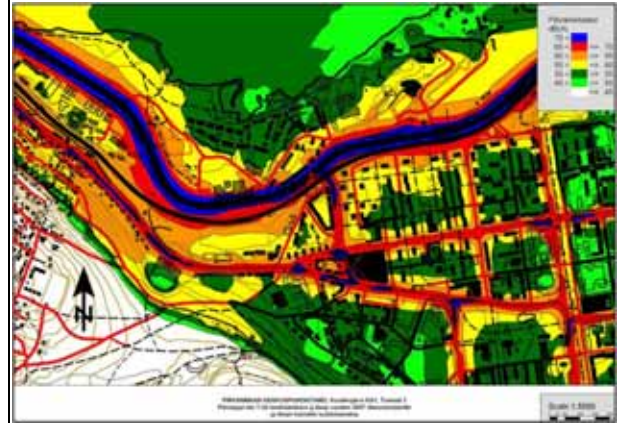
Ajotunneli C. Melualueet louheen kuljetusvaiheessa.
