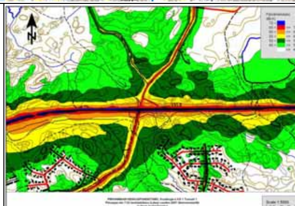
Ajotunneli A. Melualueet louheen kuljetusvaiheessa.
