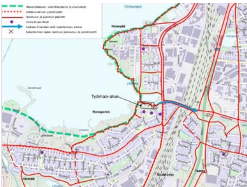
Kuva 20-6. Jalankulku- ja pyöräily-yhteydet ja rakentamisen aikaiset järjestelyt Vihilahden alueella.
