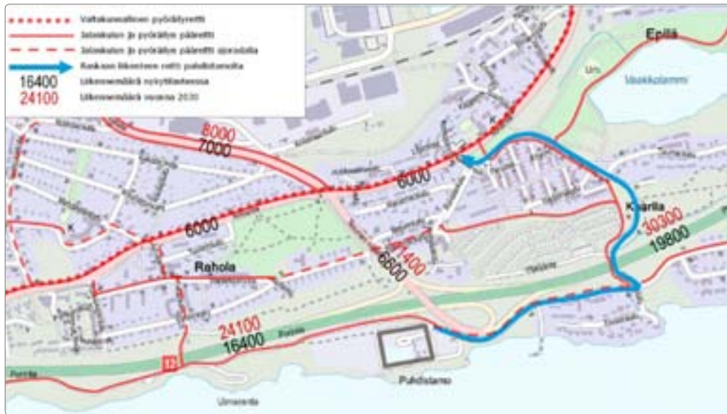
Kuva 20-2. Jalankulku- ja pyörätiet, liikennemäärät sekä raskaan liikenteen käyttämät ajoreitit Raholan jätevedenpuhdistamolla.
