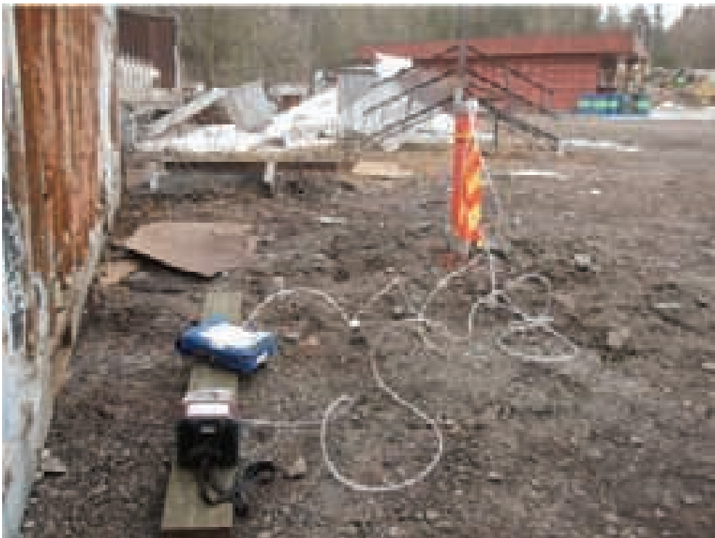
Kuva 4. Kaatopaikkakaasujen mittausta putkesta PVP2 13.4.2012
