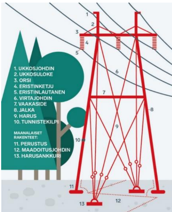
Kuva 6. Pylvään tekniset rakenteet.
