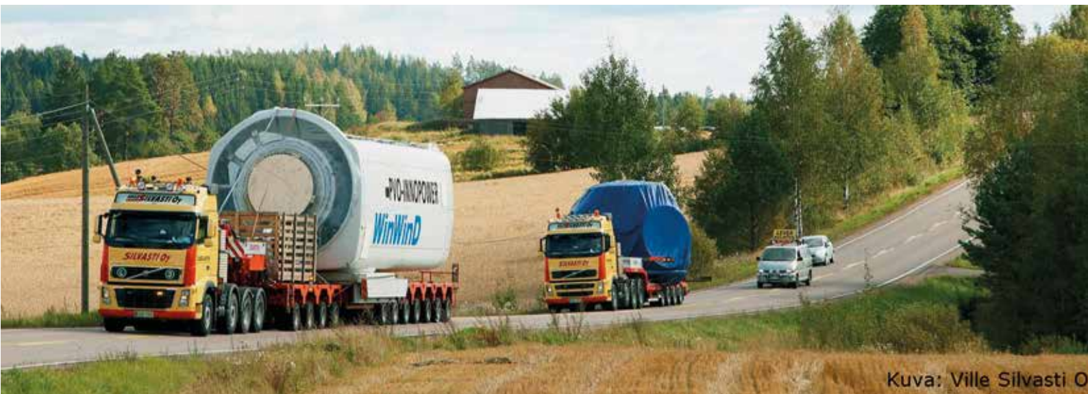
Kuva 18-17. Tuulivoimalan konehuoneen ja navan erikoiskuljetukset.
