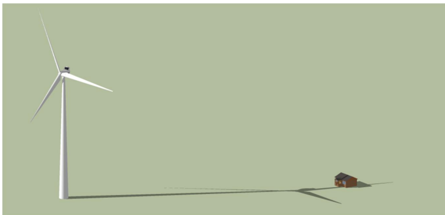
Kuva 6-70. Varjovilkkuntaa muodostuu, kun tuulivoimala pyörii tarkastelupisteen ja auringon välissä, aurinkoisella ja pilvettömällä säällä (kuva on yksinkertaistettu ja mittasuhteet eivät ole oikeat).
