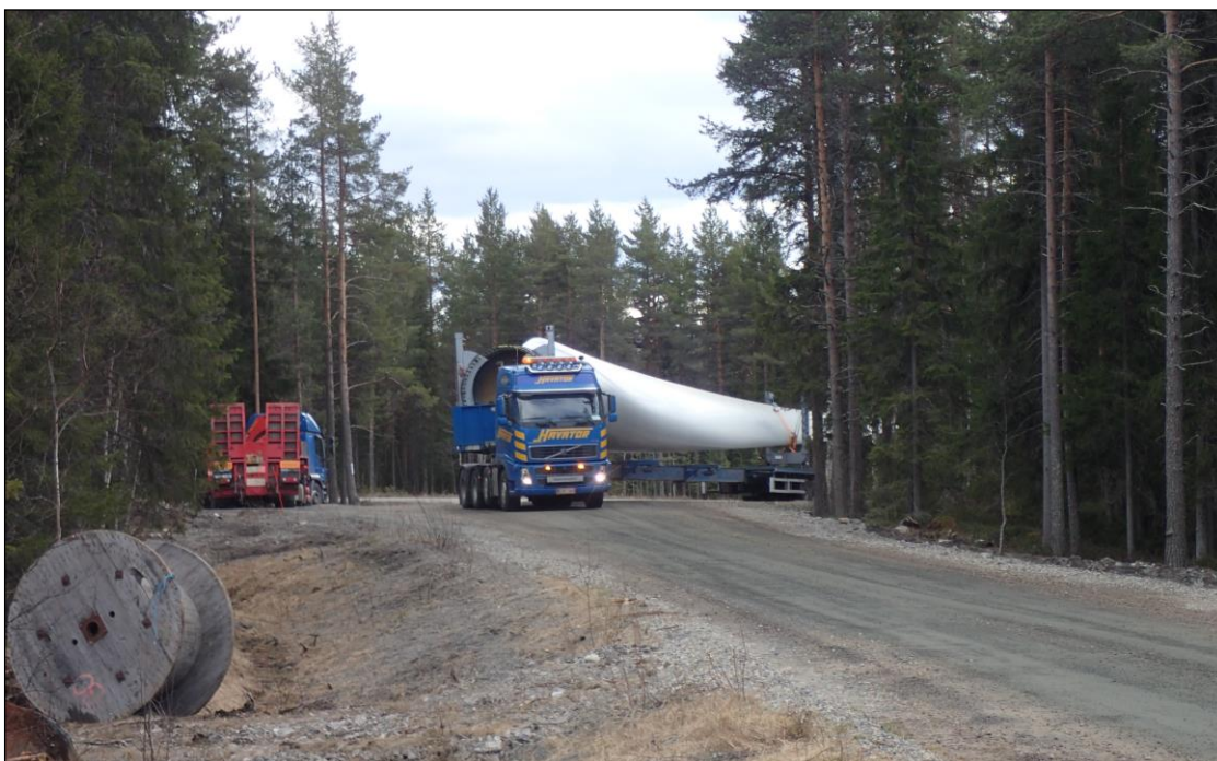
Kuva 5.5. Tuulivoimalan osia kuljetetaan erikoiskuljetuksina. (Kuva: Ville Suorsa, FCG).
