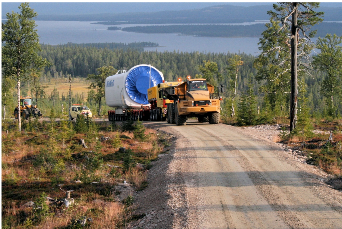
Kuva 4-2. Tuulivoimalaitoksen koneiston kuljetusta. Kuva: WinWinD ( www.winwind.com )
