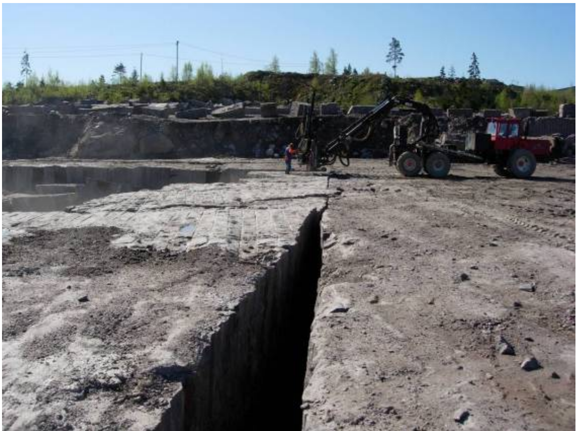
Kuva 6-2. Kamin irrotus kiintokalliosta (© P. Härmä).
