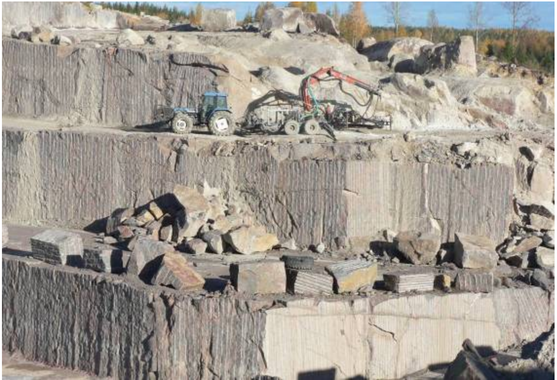
Kuva 6-1. Kallion vaakaporaus kamin irrottamiseksi.
