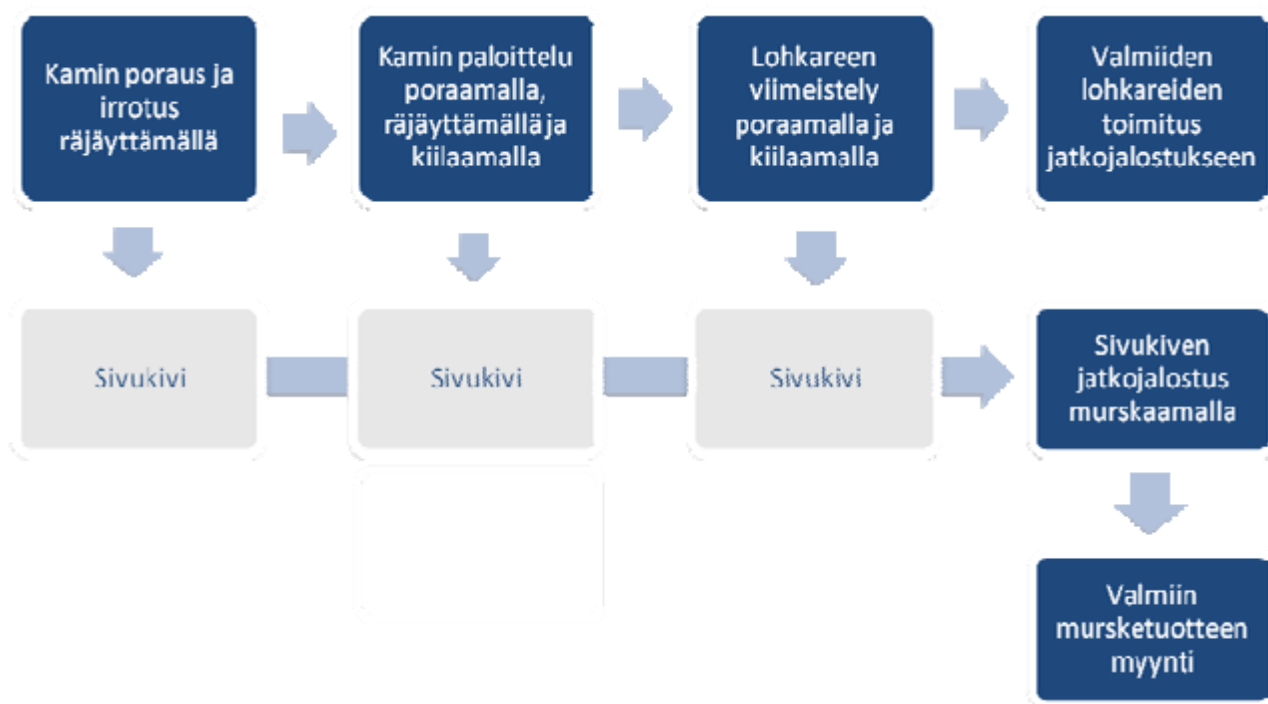
Kuva 6-6. Tarvekiven louhinnan vaiheet sekä sivukiven jatkojalostaminen.
