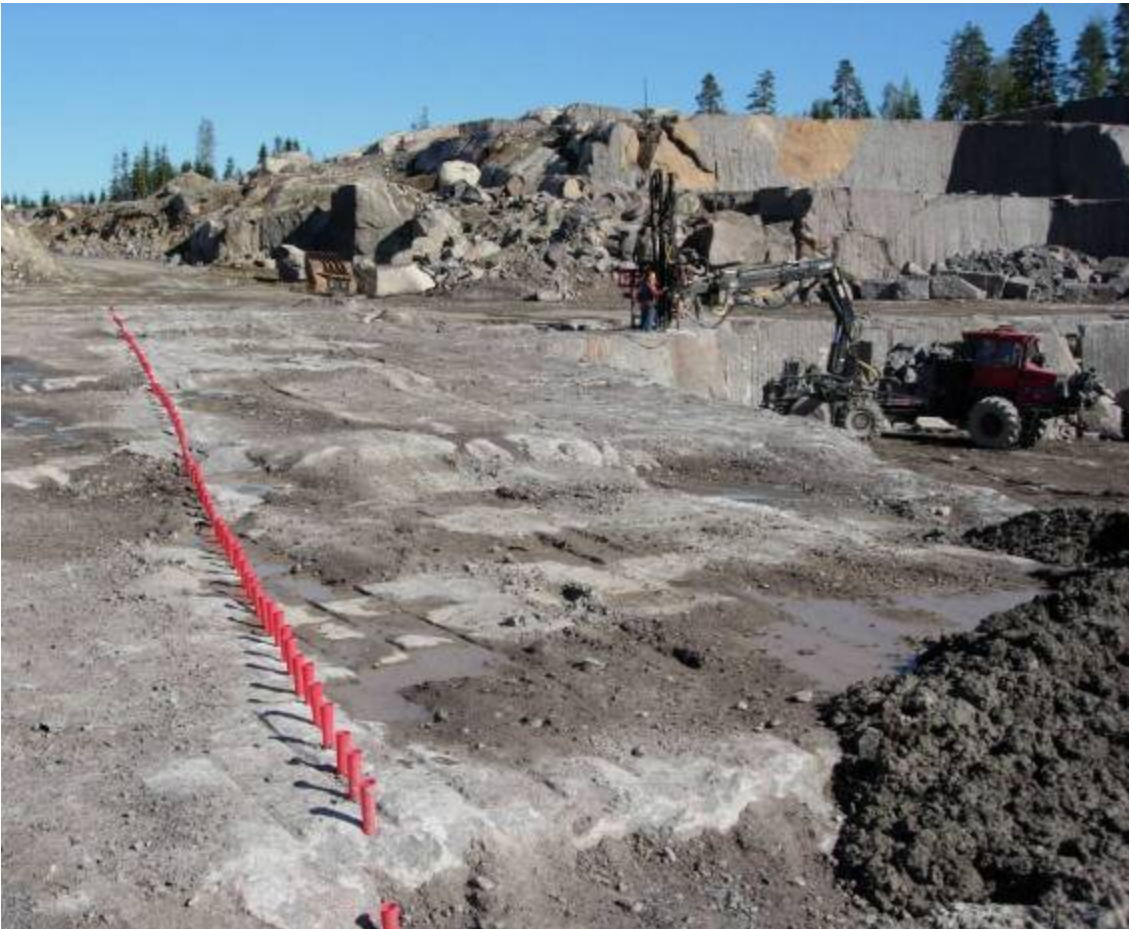
Kuva 6-4. Kamin pystyreivät valmiina panostettavaksi (© P.Härmä).
