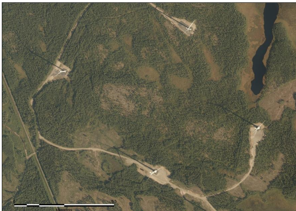
Kuva 5.1. Ilmakuvassa näkyy toiminnassa olevia tuulivoimaloita. Tuulivoimaloita varten on rakennettu huoltotiet ja nostokennät. Tuulivoimaloiden ympäristössä ja väliaalueilla aikaisempi maankäyttö on säilynyt ennallaan. Kuva ei ole Paholammin hankealueelta.
