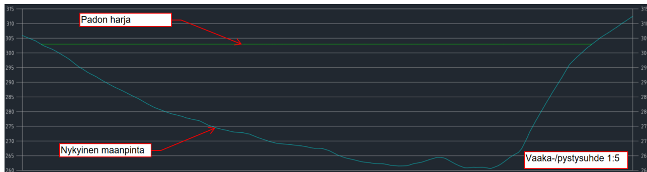
Kuva 2-10. Itäisen (suurimman) padon pituussuuntainen poikkileikkaus suurimmalla säännöstellyllä vedenkorkeudella (+300 mmpy).
