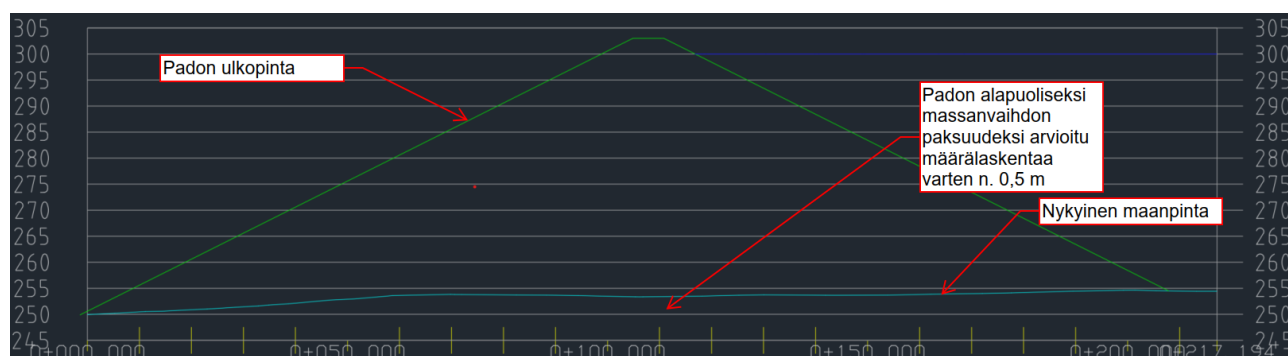
Kuva 2-9. Pohjoisen padon poikkileikkaus korkeimmalla säännöstellyllä vedenkorkeudella (+300 mmpy).
