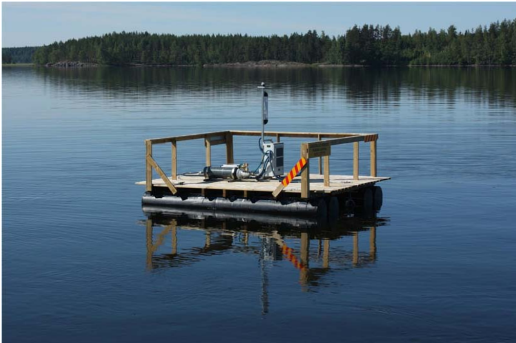
Kuva 111. Automaattinen vedenlaadun mittausasema Pien-Saimaalla.
